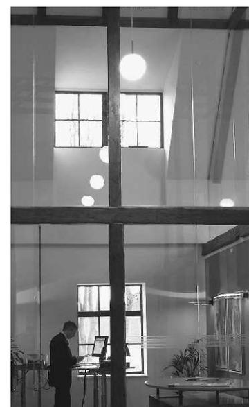
Die Leuchten enthalten eingebaute LED-Lampen der Energieeffizienzklassen **A+ oder A+ +** (EEK\*\*). Die LED- Leuchtmittel können in der Leuchte nicht ausgetauscht werden. Lebensdauer > 50.000h.
