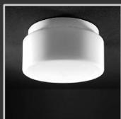
Eine unaufdringliche Leuchtenform für die moderne Raumgestaltung mit klaren zylindrischen Konturen. Wanne aus hochwertigem, mundgeblasenem Opal-Triplex-Glas seidenmatt. Metallarmatur in weiß pulverbeschichtet, werkzeuglose, 5-polige Anschlussklemme 2,5 mm<sup>2</sup> mit Lösetaste für Durchgangsverdrahtung. Zwei Leitungseinführungen. Elektronisches Vorschaltgerät (EVG). Dreipunkt- Bajonett- Verschluss zur Glasbefestigung.
