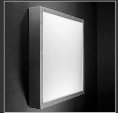
Moderne, flache, quadratische Kunststoffleuchte für Wand und Decke geeignet. Edler Aluminiumrahmen gebürstet, Kunststoffdiffusor opalweiß seidenmatt, leicht gewölbt, Stahlblech- Geräteträger weiß pulverbeschichtet, anschlussfertig verdrahtet, Diffusor über Kippfedermechanismus gehalten, werkzeugloses Wartung, elektronische Vorschaltgeräte (EVG).
